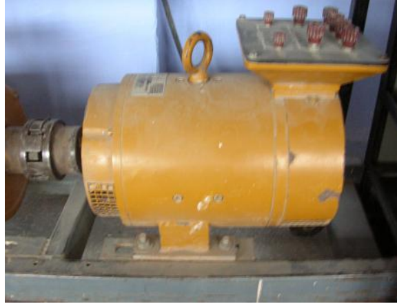
Resim 1.13: Asenkron motora akuple bağlanmış bir generatör çeşidi
