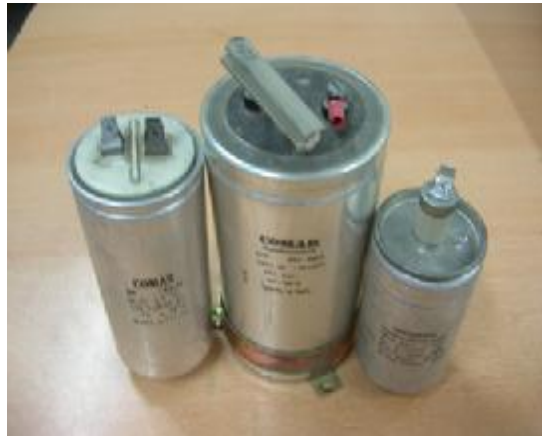
Resim 1.6: Motor bağlantılarında kullanılan kondansatör çeşitleri
