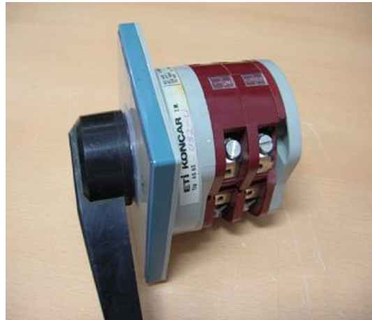
Resim 1.4: AG kompanzasyonunda kullanılan bir paket şalter
